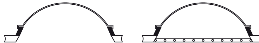
Nachrüstung von Einbruch- und Durchsturz Sicherungen (Gittersysteme)
