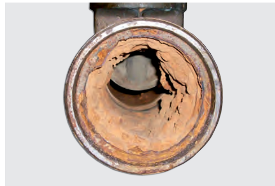
Querschnitt eines Rohrstückes
