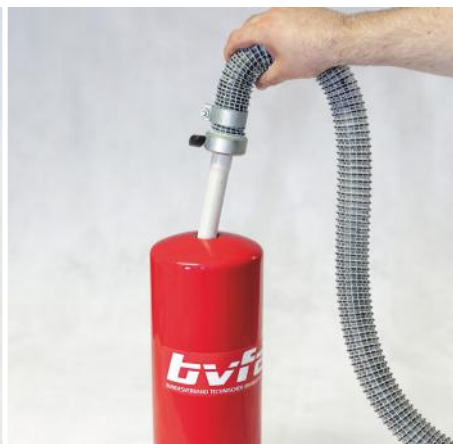
5 Entleerung des Behälters und Löschmittelkontrolle (Volumen, Menge, Zustand) 2 Min
