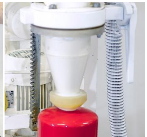
6 Befüllung des Löschmittelbehälters 4 Min
