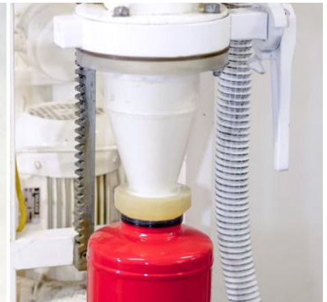
6 Befüllung des Löschmittelbehälters 4 Min
